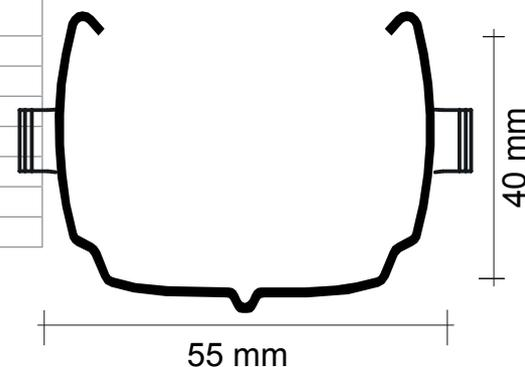
I pali con ganci esterni vengono usati per impianti di vigneti "tipo a spalliera". Si possono fornire di diverse lunghezze e vari spessori con zincatura Z100/Z275 o Magnelis, Cor-ten, o zincato a caldo in base alla richiesta del cliente.
